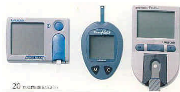
Gambar 2: Biosensor glukosa produk Lifescan. Hanya dengan setetes darah, kadar glukosa dalam darah dapat diketahui.
