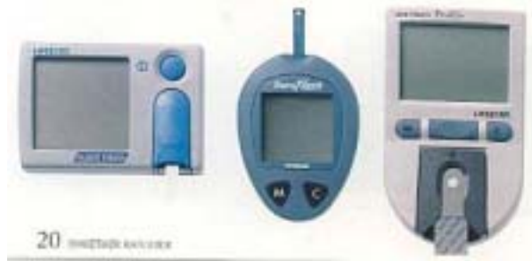
Gambar 2. Biosensor glukosa produk Lifescan. Hanya dengan setetes darah, kadar glukosa dalam darah dapat diketahui.
